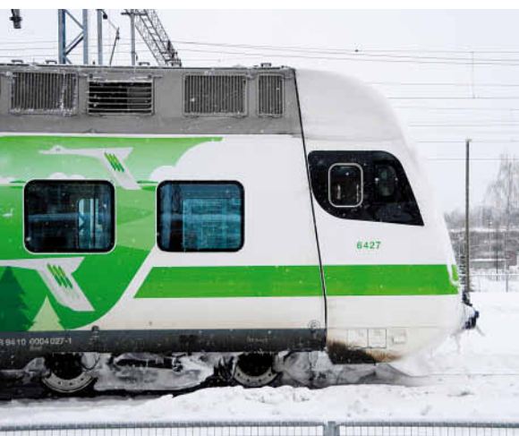
Die Eisbildung führt bei den mit 160 km/h verkehrenden Sm4-Regionalzügen zu Unterflurbeschädigungen, wenn abfallende Eisbrocken wie Geschosse aufprallen.
