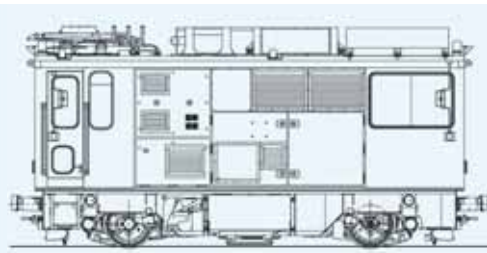
Die HGem 2/2 von Stadler werden als meterspurige Elektro- und/oder Diesel-Zahnradlokomotiven gebaut, wahlweise als Adhäsionslokomotive oder als gemischte Adhäsions- und Zahnradlokomotive.
