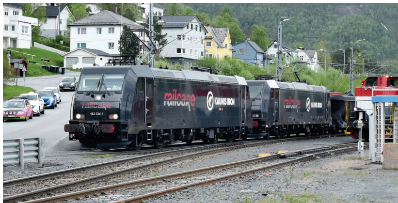
Die von Nordic Re-Finance vermieteten Re 482 werden von Railcare für Kaunis Iron vor 3000 Tonnen schweren Eisenerz-Güterzügen eingesetzt.
