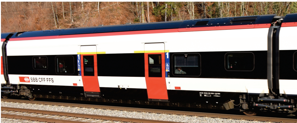
Die für den internationalen Verkehr eingesetzten Giruno-Züge von Stadler sind mit Niederflureinstiegen sowohl im ersten wie im zweiten Klassenbereich für die unterschiedlichen Bahnsteighöhen in der Schweiz, Österreich und Italien (je 55 Zentimeter) sowie Deutschland (76 Zentimeter) ausgerüstet.
