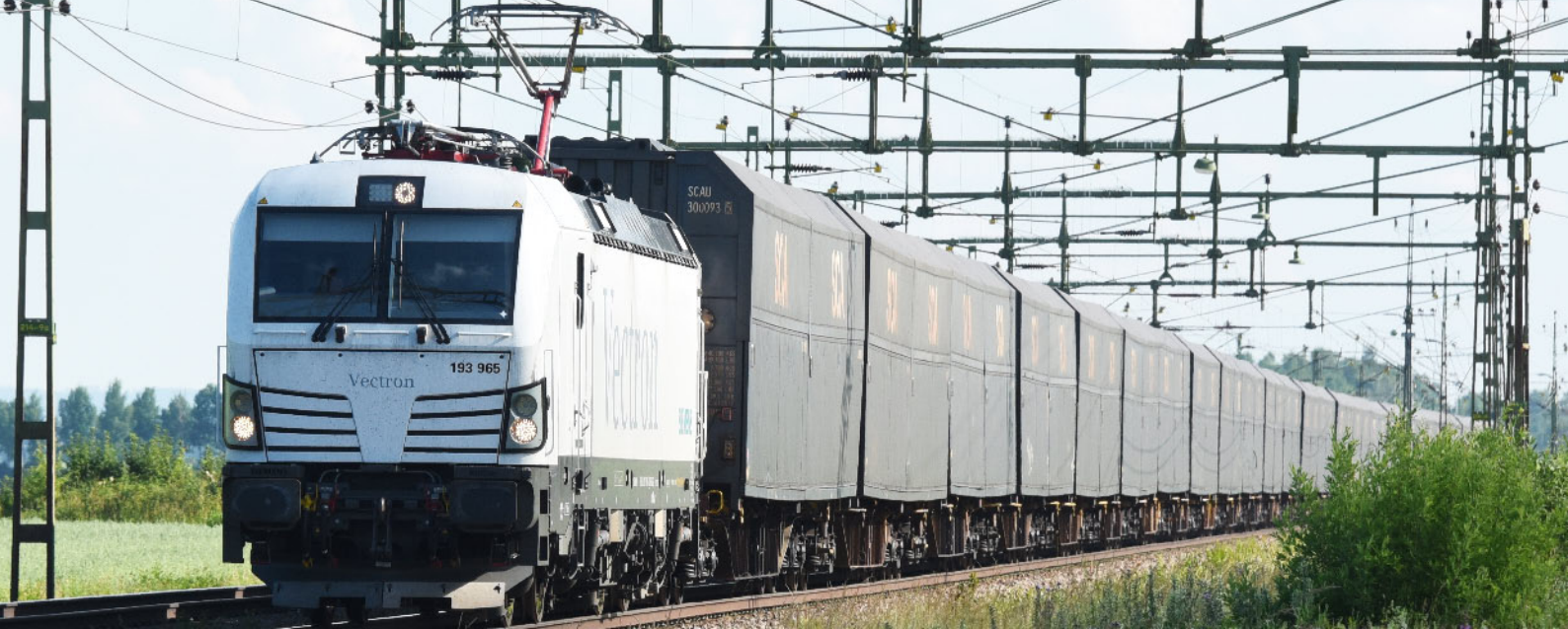
5000 Kubikmeter Holzschnitzel in 28 Wagen für das Fernwärme-Heizwerk von Stockholm Exergi, ein Zug von über 2100 Tonnen.
