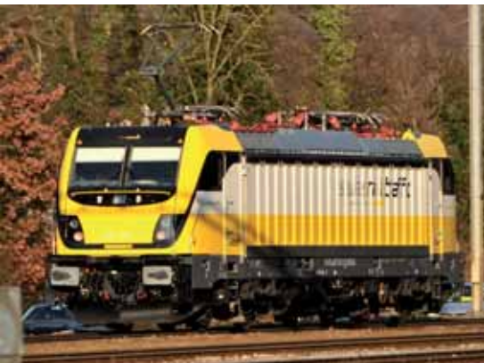
SRT betreibt seit Anfang 2015 eine TRAXX LM F140 AC3 mit ETCS-Level-2-Ausrüstung und DACH-Zulassung sowie fünf Diesellokomotiven.
