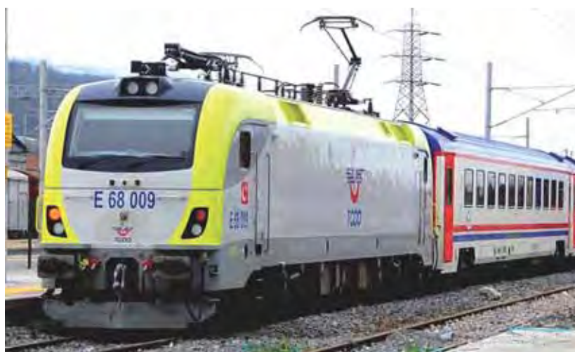
Intercity-Zug mit E68000, die für 140 km/h ausgelegt ist und zurzeit die einzige moderne IC-Lokomotive der Türkei ist.
