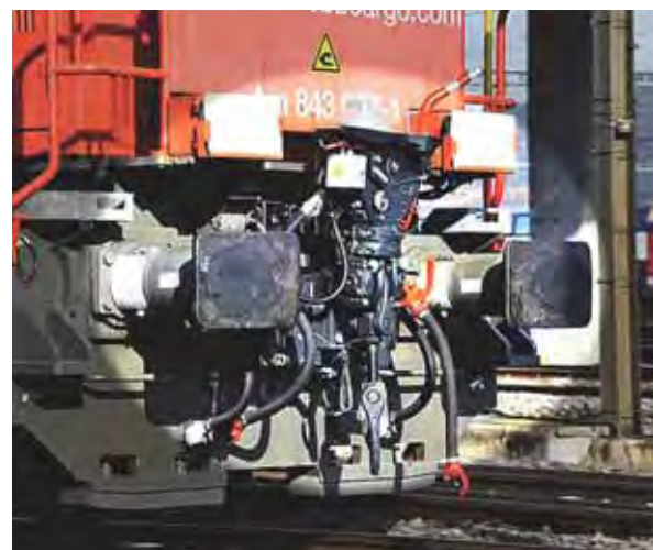
Eine Am 843 mit hochgestelltem, automatischem Kupplungsteil. Für den konventionellen Betrieb dient nach wie vor das altbekannte Schraubekupplungs-System.
